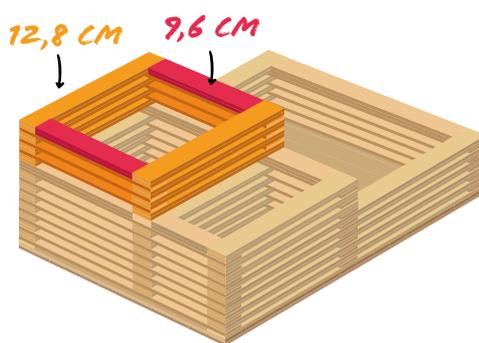
**5** Wir bauen den höchsten Teil aus Holzstäbchen mit einer halben Länge von 12,8 cm. Auf der längeren Seite des Bleistifthalters setzen wir abwechselnd 12,8 cm lange Doppelholzstäbchen (3 Stockwerke an den Rändern) auf die kürzere Seite klassische halbe Länge der Holzstäbchen 12,8 cm an den Rändern. Wir werden den dritten Stock mit 9,6 cm langen Holzstäbchen ausrichten.
